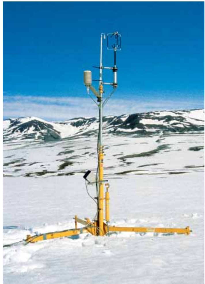
4. Landskabsmålinger med anvendelse af såkaldt eddy-korrelationsteknik hvor nettoresultatet af planternes CO_2 -optagelse og planternes såvel som jordens frigivelse af CO_2 måles. Om vinteren og i det tidlige forår dominerer frigivelsen, og landskabet som helhed virker som en CO_2 -kilde til atmosfæren. I planternes vækstsæson er det modsatte tilfældet. (C. Sigsgaard)
