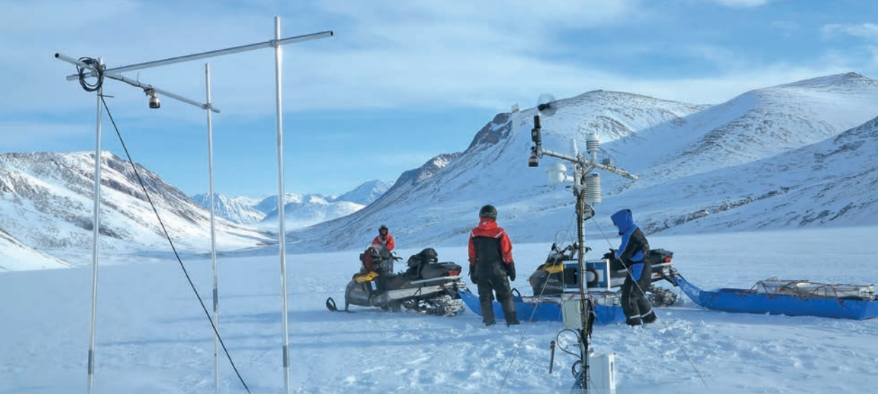
Vejrstationen på gletsjertungen af A.P. Olsens iskappe måler bl.a. temperatur, snedybde, solindstråling og vindhastighed.
